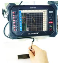
图 4 试验设备及笔式涡流检测探头
